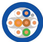
Rys. Przekrój kabla U/FTP
