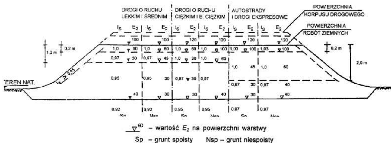
Rysunek 3 - Wartości wymagane w nasypach: wskaźnika zagęszczenia I_s i wtórny moduł odkształcenia E_2 , megapaskali
